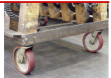
Rueda de poliuretano suave del T/R Compound de Caster Concepts después de nueve meses de operación
