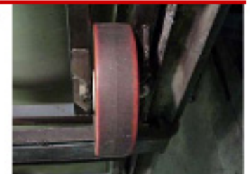
Rueda de poliuretano suave del T/R Compound de Caster Concepts después de nueve meses de operación
